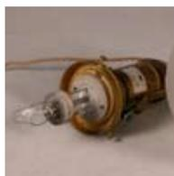
**Mode opératoire** ➤ Il suffit de brancher la lampe sur la source de courant, d'attendre une dizaine de secondes pour que le filament soit assez chaud : la lampe est amorcée et brille sans discontinuer.
